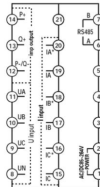
注:带\*号为电流输入进线,进出线接反,电能计量到反相电能。
